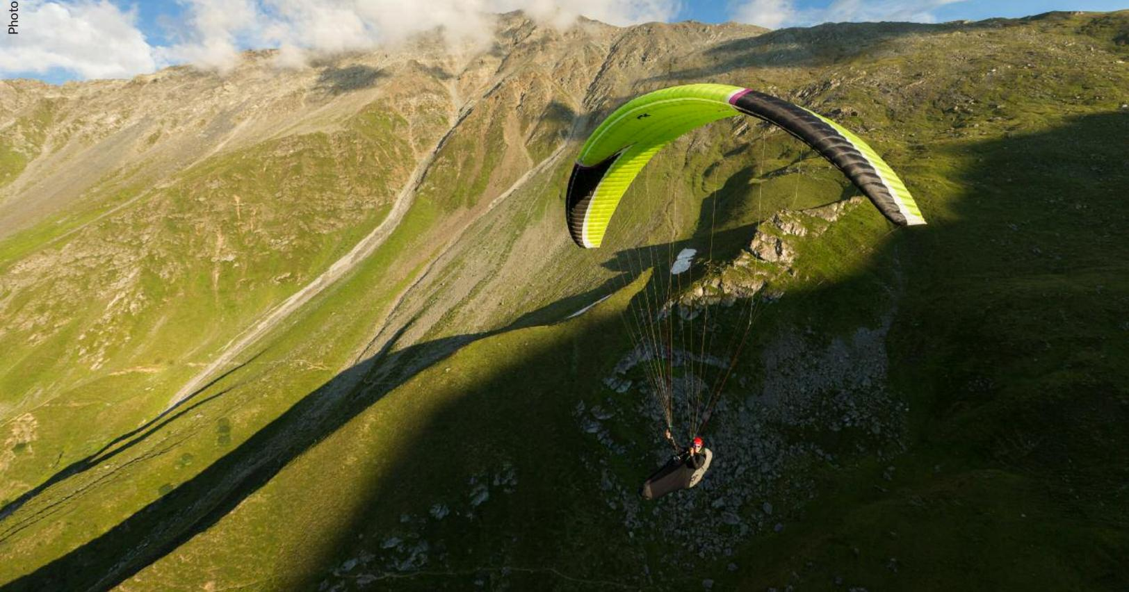
Petits vols rapides, avant un test complet. Le gonflage est facile, avec une élévation sans aucune tendance au dépassement. Prise en charge immédiate, et en vol, tout de suite un sentiment d'aile très raide, monobloc et hyper tendue. La commande est franche, un peu physique, avec une autorité évidente, par une réactivité immédiate au débatement.
