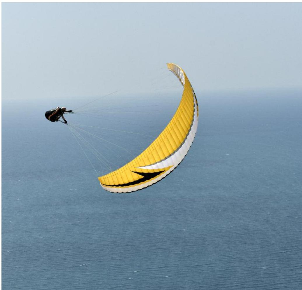
L'accélérateur est confortable, doux. L'aile accélère stablement jusqu'à 48 km/h. Trimspeed de 38 km/h et décrochage vers 23 km/h sous cette taille M.
