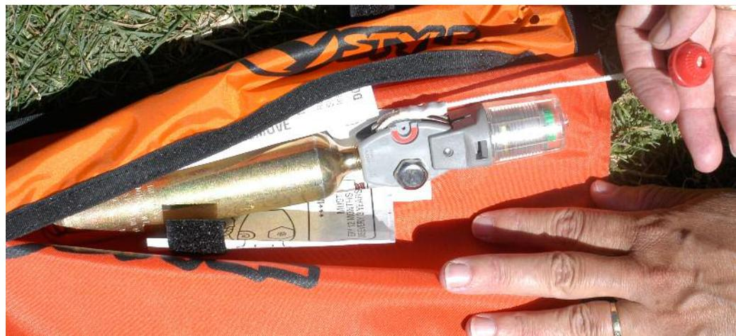
Un déclencheur mixte automatique/manuel et sa bouteille de CO<sub>2</sub>.
