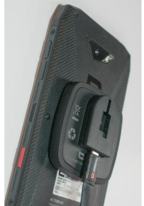
**La plaque magnétique du kit d'accessoire Car-Kit peut également servir à plat sur le cockpit, puis en voiture au retour. Cette prise peut remplacer la connexion USB. Elle remplace également la fonction "charge par induction" du Trekker X3, bien plus lente.**
