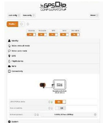
**L'instrument n'a pas de liaison Bluetooth, mais se connecte facilement via un câble USB à un smartphone ou une tablette (USB compatible "OTG").**
