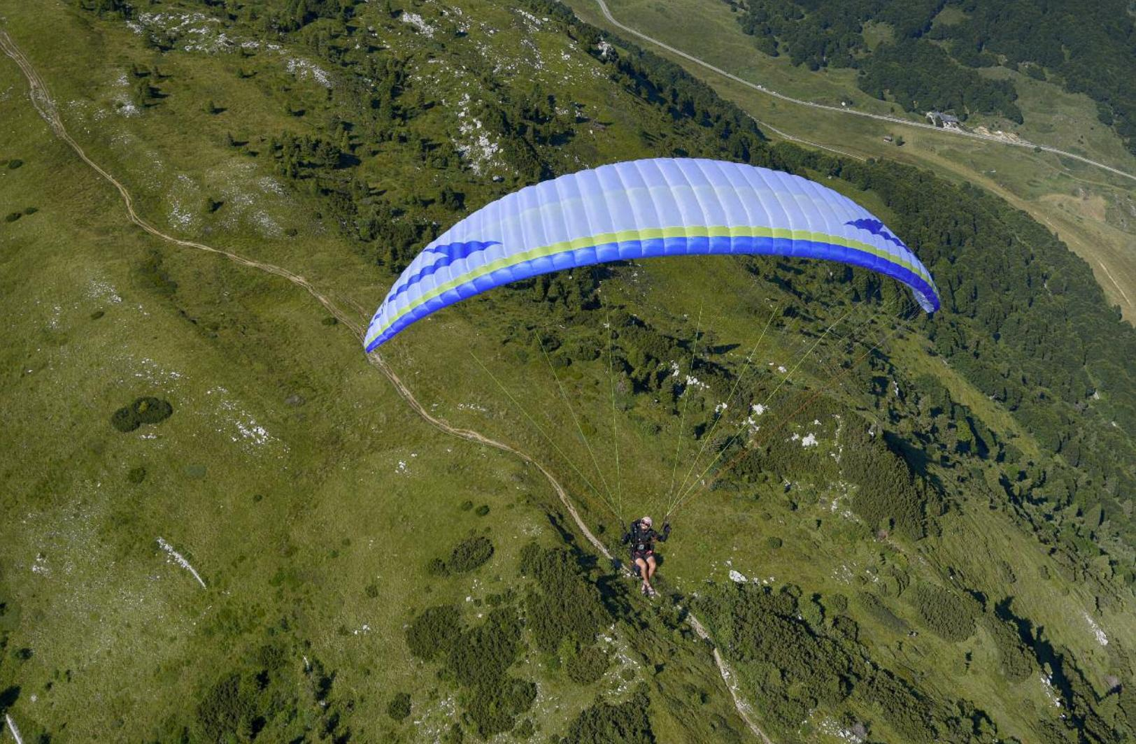
**L'aile ne shoote pas seule. Pour l'amener là, il fallait une manœuvre bien dynamique. Bien visible : les Mini-Ribs en bord de fuite.**
