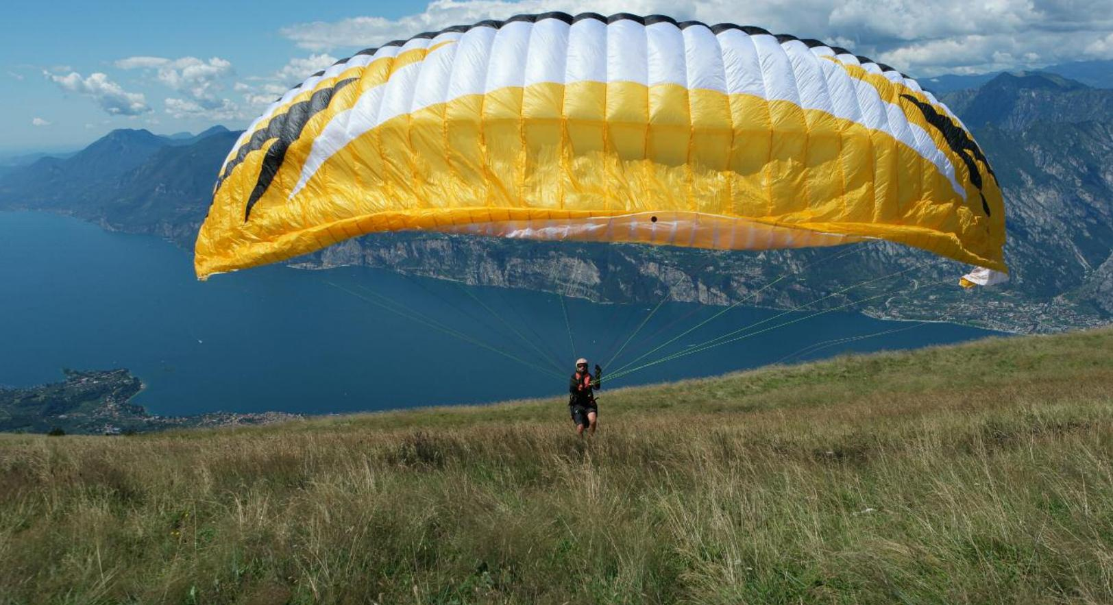
**Bien visible au décollage : le gonflage retardé de la partie arrière. C'est un avantage en paramoteur aussi : nous allons faire des tests dans ce sens.**
