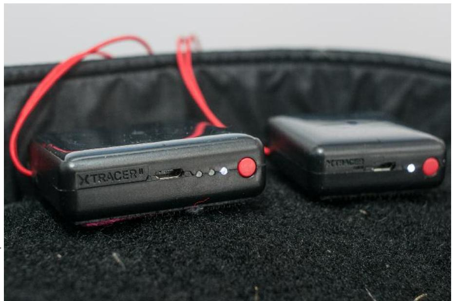
le XC Tracer II a gauche communique via USB, Bluetooth et LED. Il est alimenté par son panneau solaire tout comme le XC-Tracer Mini à côté.
